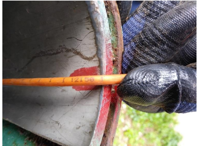
Figura 4 - Ripresa di dettaglio del valore di profondità rilevato sul cavo metrico della sonda freaticometrica.
