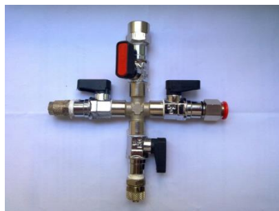
Figura 6- Raccorderia per il sistema di rilievo pneumatico del livello piezometrico
