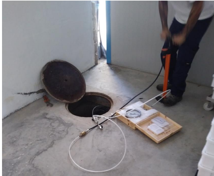
Figura 8 - Sistema di misura pneumatica con pompa manuale in fase di acquisizione
